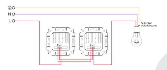
2.4 Collegamento di un dimmer con pulsanti di controllo dell'illuminazione Tale schema consente di controllare l'illuminazione da più di due punti.
